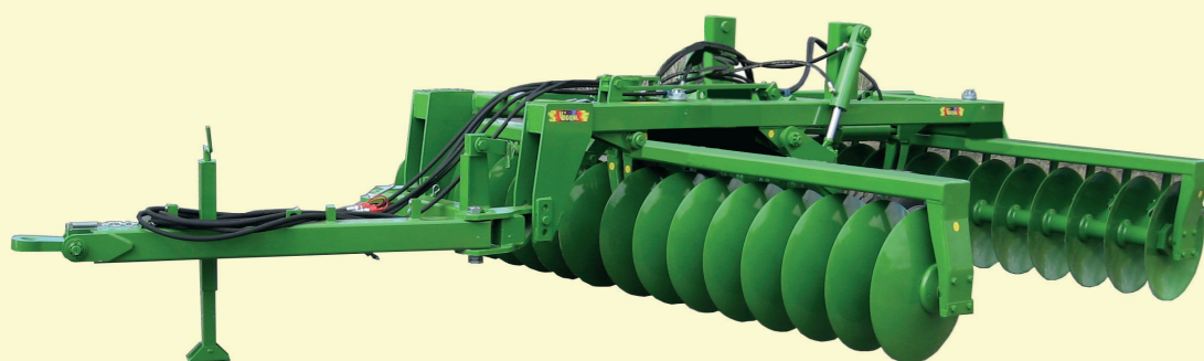
Cuscinetti oscillanti Ø mm 65 con supporto in acciaio sulla serie OTI 66 e OTI 71
